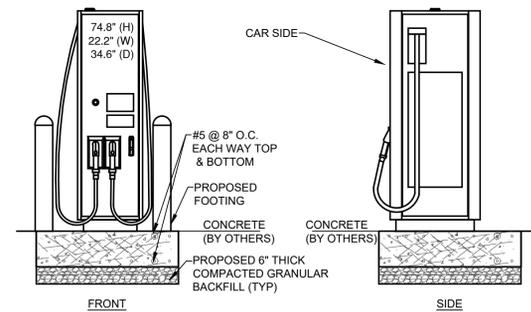
**A** EV CHARGER ELEVATION DETAIL
