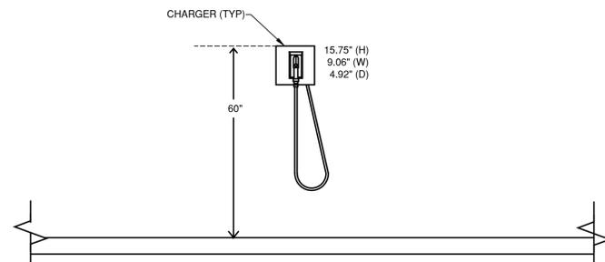
**B** EV CHARGER ELEVATION DETAIL
